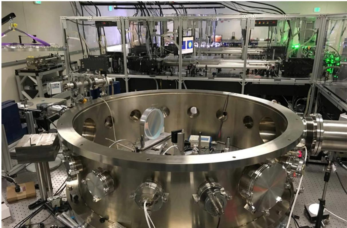
*Im Vordergrund ist die Reaktionskammer (Target Chamber) und im Hintergrund ist der Laser (Ultra-high density laser) zu sehen der bei den Mikro-Fusionsexperimenten der CSU genutzt wurde.*
