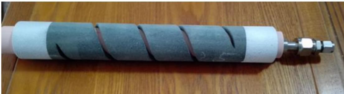
*Der Bericht stammt von der chinesischen Atom-Akademie, (?) das Experiment wurde von Zhang Xian (?) durchgeführt. Der Reaktor besteht aus einem Nickelrohr von 210 mm Länge und hat einen Innendurchmesser von 4 mm und einen Außendurchmesser von 6 mm. Das offene Ende des Tubus ist mit Aluminiumoxidfaserbaumwolle versiegelt. Das mit Brennstoff gefüllte Nickelrohr wurde dann in einen Korundbehälter (8 mm Innendurchmesser, 500 mm Länge) eingeführt.*
